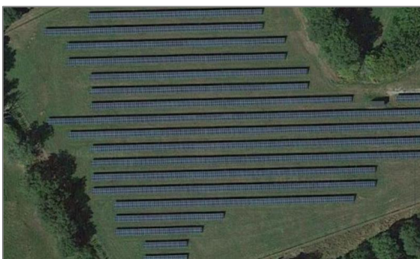
Différences d'occupation du sol entre des tables orientées au sud et des tables est-ouest
