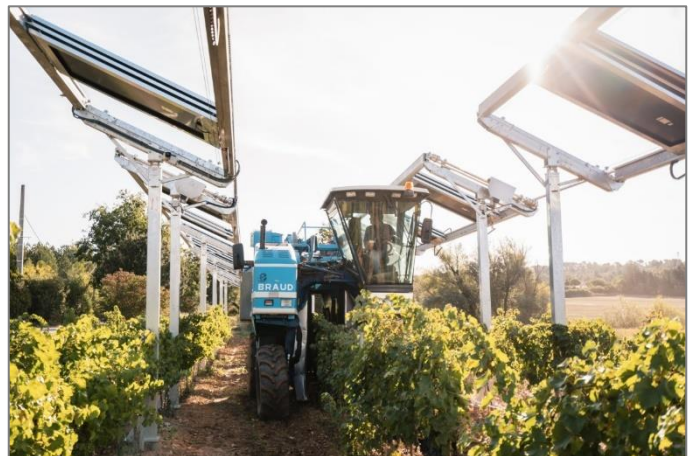
Passage d'engins mécanisés sous panneaux (Source : Ombrea)
