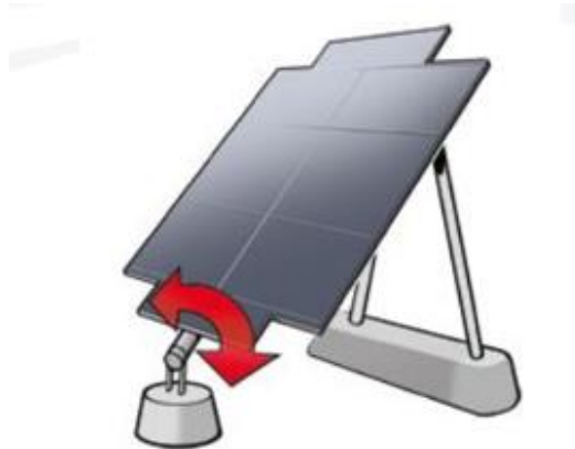
Schéma 8 : Illustration d'un suiveur est-ouest avec un axe incliné (Source : Solar Choice Pty, Ltd, 2010)
