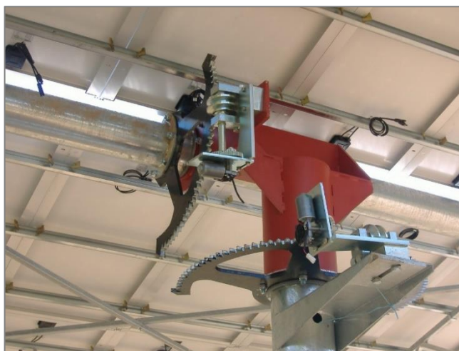
Photographie 4 : Trackers à deux axes SOLON et FEINA (Source : ENCIS Environnement)
