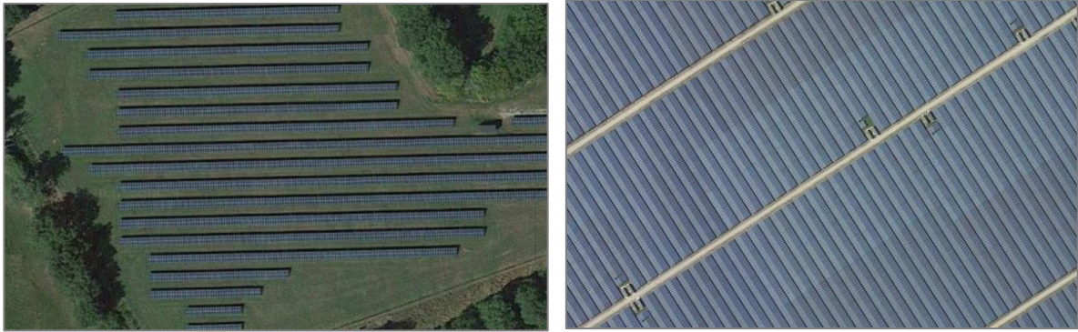
Figure 2 : Différences d'occupation du sol entre des tables orientées au sud et des tables est-ouest (Source : géoportail)
